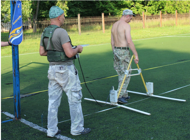
Рис. 7. Пошуки залишків втрачених архітектурних об'єктів за допомогою георадару. Фото надане І.С. Кедуном
