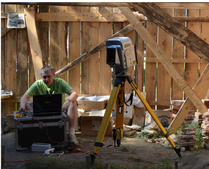
Рис. 18. Сканування 3D сканером залишків північної прибудови Спасо-Преображенського собору в Чернігові. Фото 2012 р.
